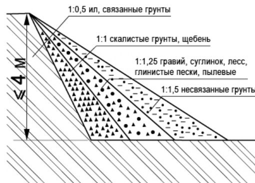
Рис. 6. Безопасный наклон откоса
